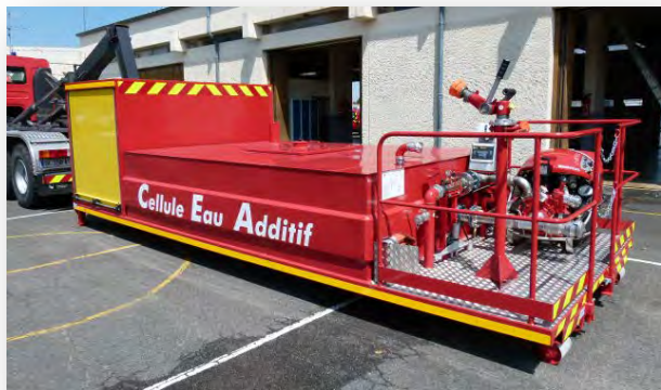
Cellule Eau – Additif (CEAD)
